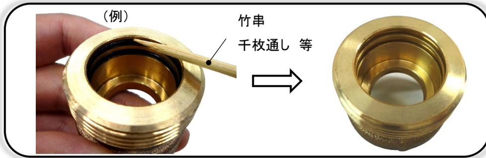
(注) 千枚通しなどの金属製のものを使用する場合は、右図中
