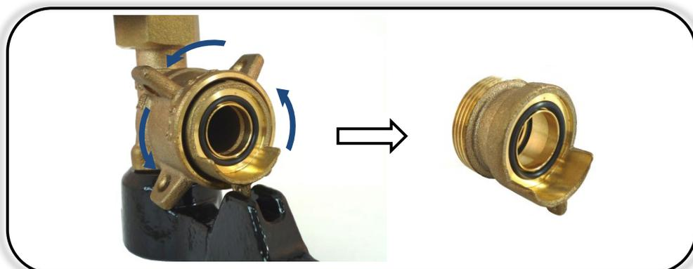
2. スライドホルダを手に取り、先端が尖っているものを用いて O リングを外す。
