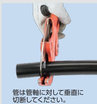
管は管軸に対して垂直に切断してください。
